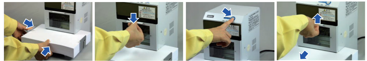
センターゲージで揃える カバーをおろす (カバーをおろさないで穿孔しない安全設計) スタートボタンを押す(穿孔) カバーを上げ取出す
