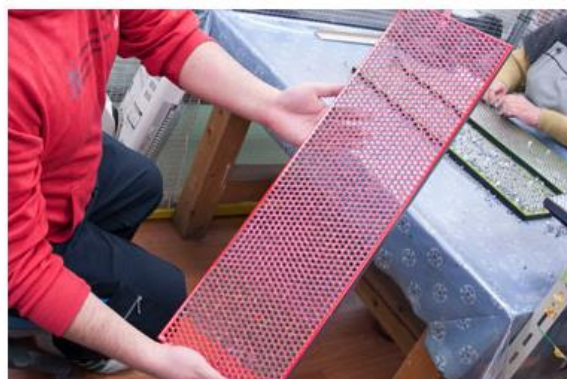
ネジの頭を塗装するために使うプレート。 これ一枚で1600個ものネジを一度に塗装可能。
