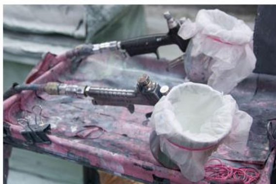
塗料を吹きつける「スプレーガン&カップ」。 使う塗料によって使い分ける。
