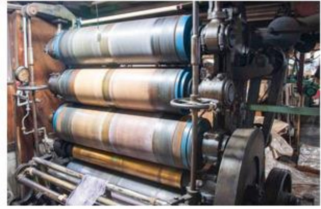
写真1 艶出しの加工機
