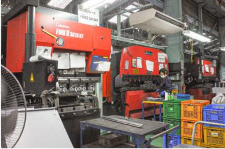
工場内に設置されている3台の赤いプレスブレーキ（曲げ加工機）。用途に応じて使い分けている。
