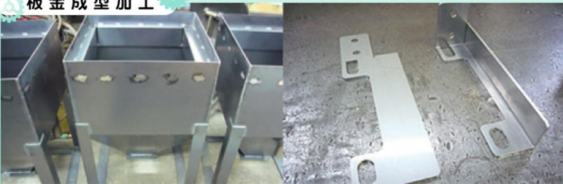
レーザー加工機によるブランク加工から、大小様々な一般成型品、板バネの製作まで。複雑な折り曲げも可能です。
